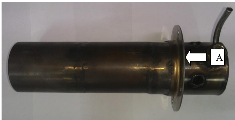
Рис.23 Горелочное устройство подогревателя
